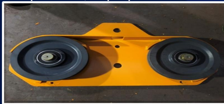
Шкив крюка имеет новую конструкцию, предотвращающую падение крюка.
