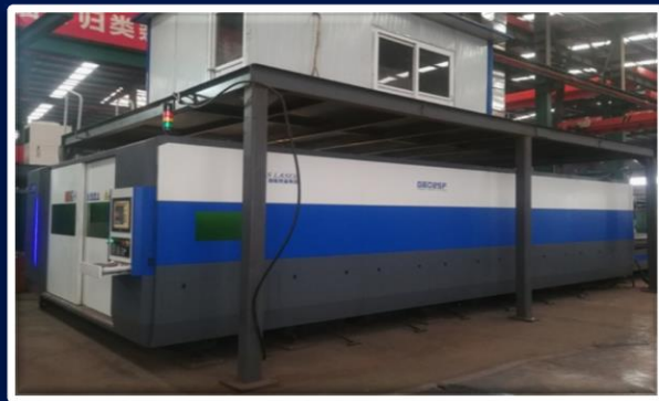
Станок для лазерной резки листов мощностью 12000 Вт
