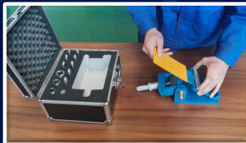
Эксперимент с нанесением покрытия на цилиндр – рический гибочный инструмент (гибкость покрытия)
