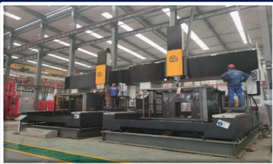
Фрезерование после сварки всего каркаса
