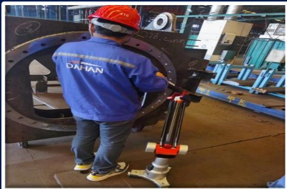
Проверка трехкоординатного измерительного прибора на шарнирном рычаге
