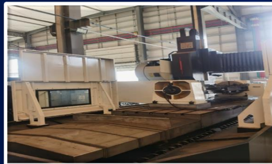
Обработка рамы привода после сварки
