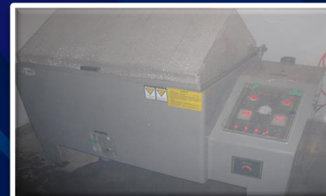
Машина для испытания соевым распылением (антикоррозийные свойства покрытия)
