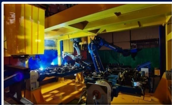
Роботизированное рабочее место для сварки настенного каркаса лифта
