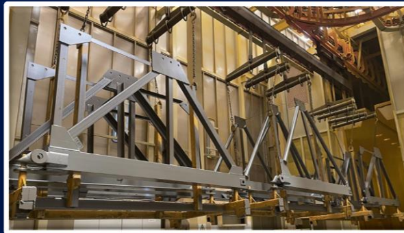
Предварительный нагрев с использованием инфракрасного излучения
